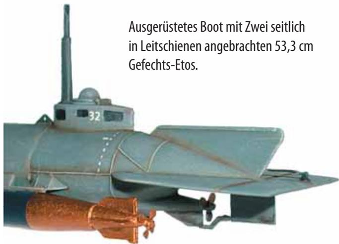
Ausgerüstetes Boot mit Zwei seitlich in Leitschienen angebrachten 53,3 cm Gefechts-Etos.
